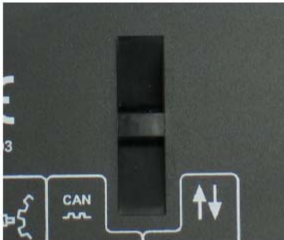
Punto de fijación de cable
